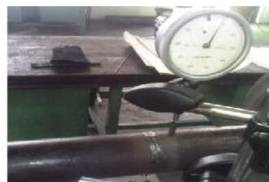
Gambar 4. Proses pengujian hasil pengelasan dengan menggunakan welding fixture
